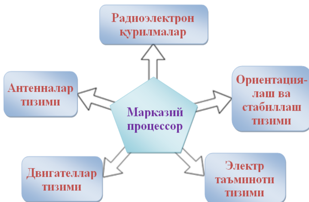
13.2-расм. Сунъий йўлдош-ретрансляторнинг умумий тузилиш схемаси
