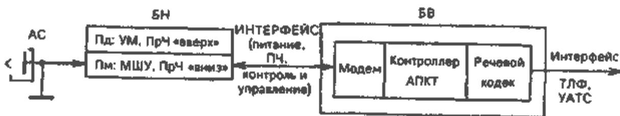
Рис.5. Функциональная схема станции VSAT-ТЛФ
