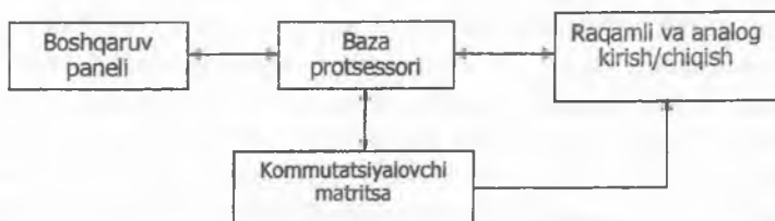
7.15 - rasm. Raqamli miksher pultining struktura sxemasi.
