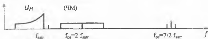
9.10-rasm. ChM-ChM tizimidagi KSS spektri.
