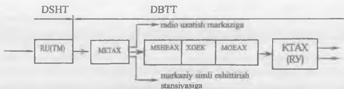
7.22 - rasm. Dasturlarni birlamchi taqsimlash trakti struktura sxemasi.
