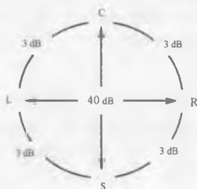
9.18-rasm. Passiv dekoderning funksional sxemasi
