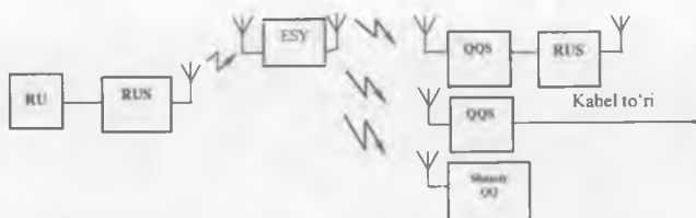
2.5 - rasm. Sun'iy yo'ldosh orqali ovoz eshittirish struktura sxemasi
