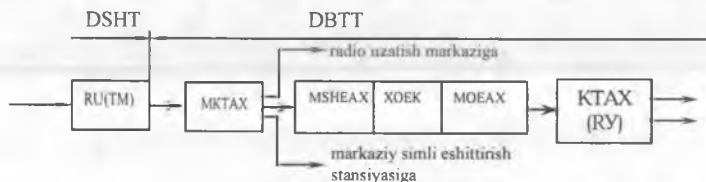
7.22 - rasm. Dasturlarni birlamchi taqsimlash trakti struktura sxemasi
