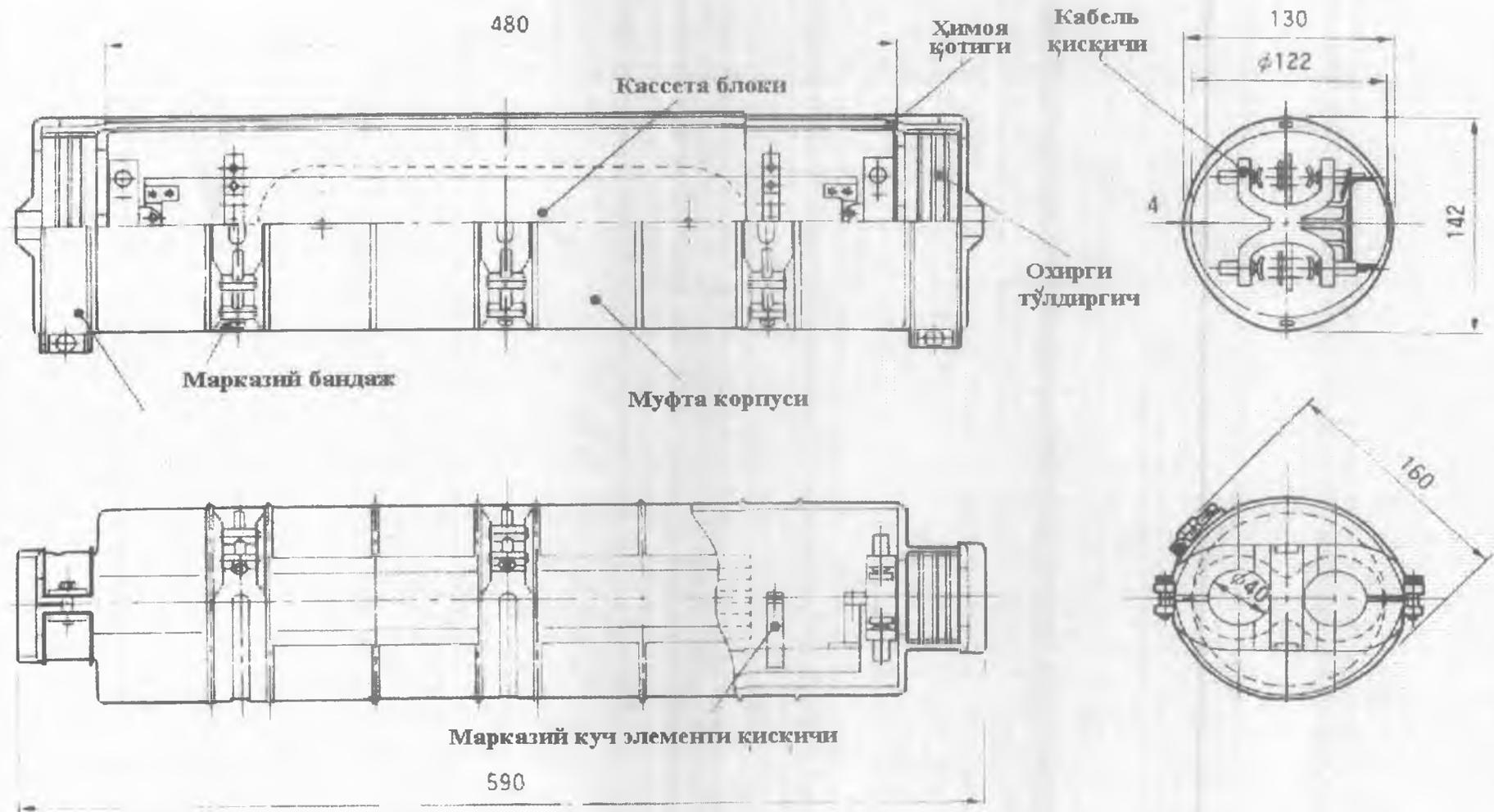
3.18 -расм. FSCO – SB муфта конструкцияси
