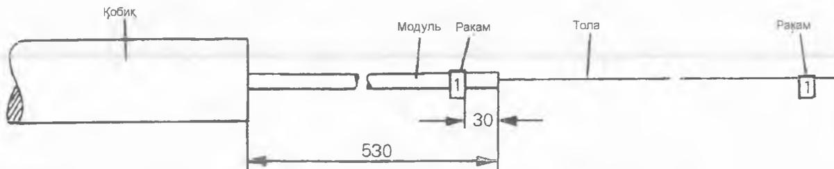
3.38-расм. Модуларни қисқартириш ва толаларни рақамлаш
