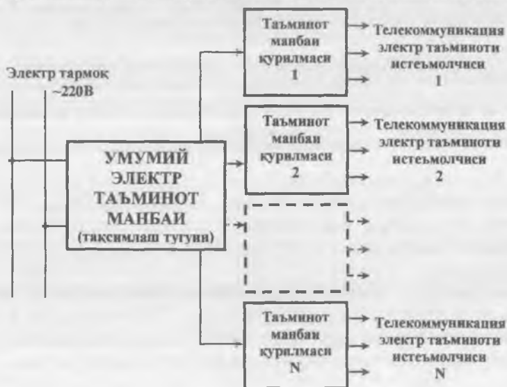
9.2-расм. Тақсимланган электр таъминот манбаи схемаси.
