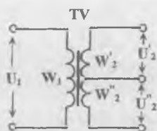
3.30-расм. Бир фазали токни икки фазали токка ўзгартириш схемаси.
