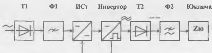
6.12-расм. Инвертордан олдин стабилизатор қўйилиши билан стабиллаш амалга ошириладиган трансформаторсиз киришли электр таъминоти манбаининг тузилиш схемаси.
