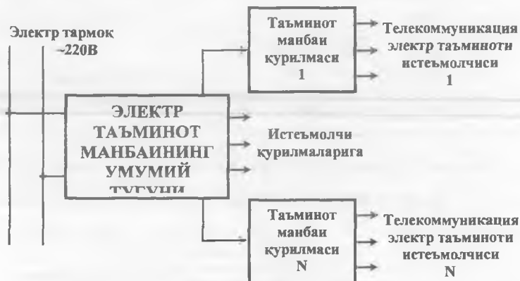
9.3-рasm. Жамланган электр таъминот манбаи схемаси.
