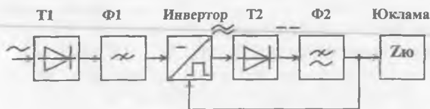
6.13-расм. Инверторда кенглик–импульсли модуляция услуги билан стабиллаш амалга ошириладиган трансформаторсиз киришли электр таъминоти манбаининг тузилиш схемаси.
