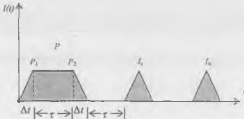
32.12-rasm. Chekkaviy va ko'p karrali sado. R uyg'otuvchi impuls, \Delta t va \tau chekkani davomligi va davomlilik, I_s - chekkaviy sado, I_k - ko'p karrali sado.
