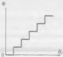
29.11-rasm. Halqa teshigida ushlanib qolgan magnit oqimi tashqi magnit maydon induksiyasiga bog'liqlik grafigi.
