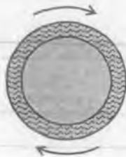
28.2-rasm. Ikkita konsentrik silind yordamida suyuqlik yopishqoqligini o'Ichash.
