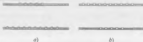
22.4-rasm. a) termodinamik muvozanat; b) inversiya holati.
