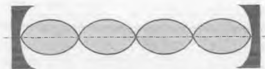
22.7-rasm. Rezonatorlarda turg'un to'lqin.
