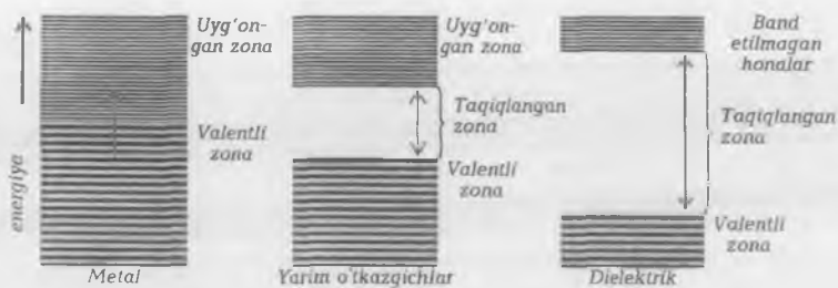
27.5-rasm. Metall, dielektrik va yarim o'tkazgichlar uchun taqiqlangan va o'tkazuchan zonalar.
