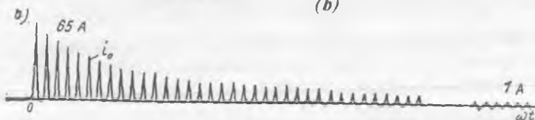
8.5-rasm. Yuklama ulanmagan o'rtta quvvatli bir fazali transformatorni elektr tarmog'iga bevosita qo'shish sxemasi (a) va bu jarayondagi tok ossillogrammasi (b)
