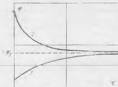
33-расм. Материал намунаси намланиш (1) ва қуриш (2) жараёнида ундаги намликнинг вақт бўйича ўзгариши.
