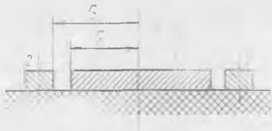
15-расм. Диэлектрик сирт қаршилигини аниқлаш учун ишлатиладиган доврайсмон ички (1) ва ташқи (2) электродлар.
