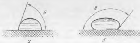
32-расм. Намланадиган (а) ва намланмайдиган (б) диэлектрик сиртдаги сув томчиси.
