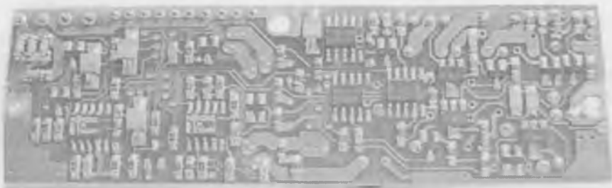
9.1-rasm. Yuzaga montaj qilish texnologiyasida tayyorlangan bosma plata.
