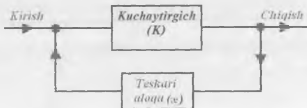
8.8-rasm. TAl i kuchaytirgichning tuzilish sxemasi.
