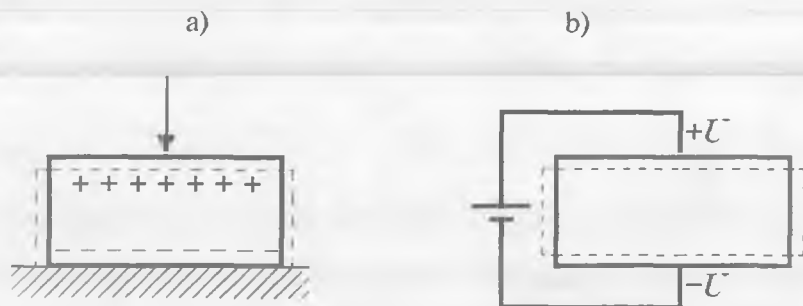
13.8-rasm. To‘g‘ri (a) va teskari (b) pyezoeffekt.
