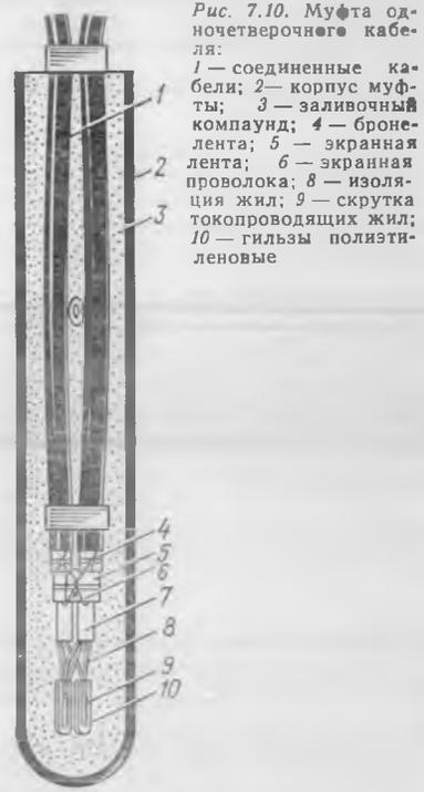
Рис. 7.10. Муфта одночетверочного кабеля:
