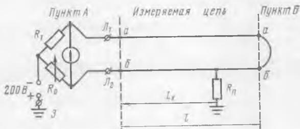
Рис. 11.1. Схема измерения для определения расстояния до места повреждения изоляции жил по отношению к земле мостом с переменным отношением плеч
