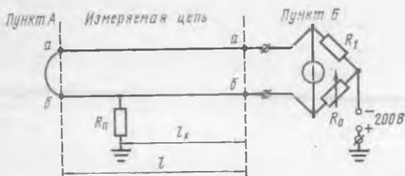
Рис. 11.2. Схема дополнительного измерения из пункта Б мостом с переменным отношением плеч
