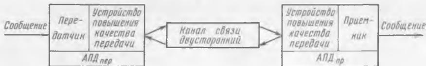
Рис. 6.8. Структурная схема системы передачи данных
