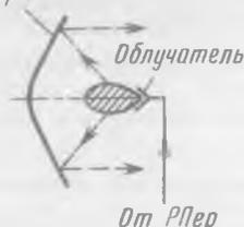
Рис. 11.22. Принцип построения однозеркальной параболической антенны
