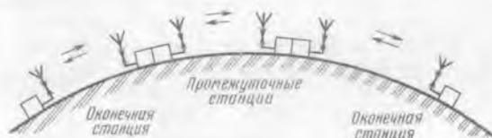
Рис. 7.16. Схема радиорелейной линии связи
