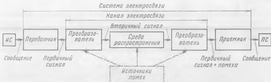
Рис. 5.3. Структурная схема системы электросвязи
