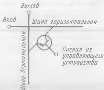
ние одного из входов с определенным выходом. Контакт срабатывает при подаче тока в обмотку данного реле. Для этого должны замкнуться соответствующие ключи в цепях управления процессом коммутации. Например, для срабатывания реле  $P_{12}$  необходимо замкнуть ключи 1 и 2 г. Контакт этого реле замкнется и соединит вход 2 с выходом 1. Если замкнуть ключи  $tb$  и  $ng$ , сработает реле  $P_{mn}$  и вход  $n$  соединится с выходом  $m$  и  $t$ . д.
