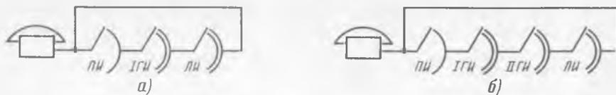
Рис. 9.20. Упрощенные структурные схемы АТС на 1000 (а) и 10 000 (б) номеров
