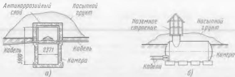
Рис. 10.3. Устройство НУП с вертикальной камерой для симметричного кабеля (а) и горизонтальной цистерной для коаксиального кабеля (б)
