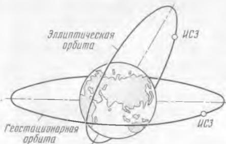
Рис. 11.30. Эллиптическая и геостационарная (круговая) орбиты для искусственного спутника Земли
