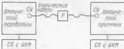
Рис. 10.21. Структурная схема волоконно-оптической системы передачи с ВРК: СУ — согласующие устройства; Р — регенератор; СП — система передачи
