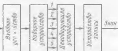
Рис. 9.29. Структурная схема приемника дискретной системы связи
