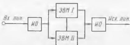
Рис. 9.34. Упрощенная структурная схема ЦКС с двумя ЭВМ
