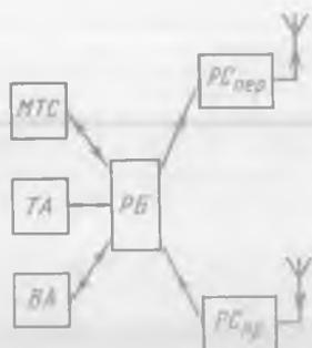
сигналов электросвязи, например: междугородной телефонной станцией МТС, телеграфной аппаратной ТА, вещательной аппаратной ВА. Структурная схема, поясняющая взаимодействие радиобюро с источниками сигналов — передающими РС<sub>пер</sub> и приемными РС<sub>пр</sub> радиостанциями, показана на рис. 11.4. Сигналы программ звукового вещания поступают из ВА, телефонные сигналы — из МТС, а телеграфные — из ТА.
