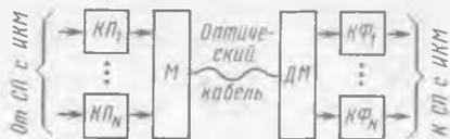
Рис. 10.22. Структурная схема волоконно-оптической системы передачи с ЧРК
