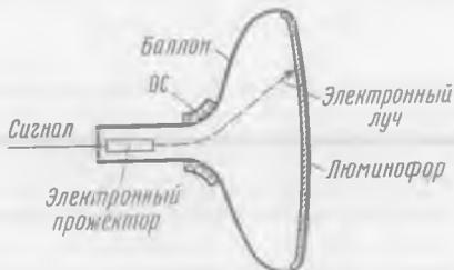
Рис. 6.7. Приемная телевизионная трубка (киноскоп)
