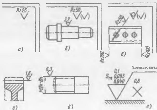
Рис.-3.1. Обозначение шероховатости поверхности (по О`з DSt 646-95).
