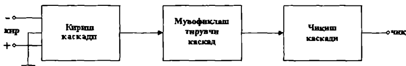
9.15-расм. Уч каскадли ОК функционал схемаси.
