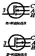
6.7-расм. n - канали индукцияланган МДЯ – транзистор тузилмаси (а) ва n – ҳамда p – МДЯ транзисторларнинг график шартли белгиланиши (б).
