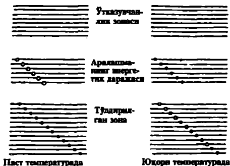
1.6-расм. Акцепторнинг ярим ўтказгичдаги электролар сатҳларининг энергетик схемасига таъсири.
