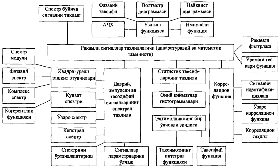
10.29-расм. Ҳозирги замон рақамли спектр таҳлилагичининг функционал имкониятлари
