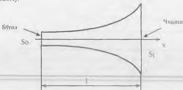
6.26 – расм. Экспоненциал рупор: S_0 – рупор бўғзи юзаси; S_1 – рупорнинг чиқиш юзаси; l – рупор узунлиги.
