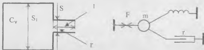
4.10 расм. Гельмгольц резонатори (а) ва унинг механик эквивалент схемаси (б)
