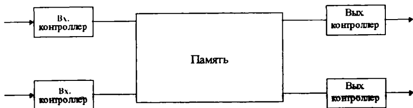
Рис. 6.1. Базовая структура коммутатора ATM с общей памятью
