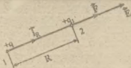
5.1-расм. Электростатик майдондаги икки нуқтавий зарядларнинг ўзаро таъсир кучини аниқлаш.
