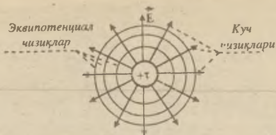
5.6-расм. Иккита яккаланган мусбат зарядланган ўтказгичларнинг электростатик майдони (манфий зарядланган ўтказгич чексиз узоқда жойлашган)
