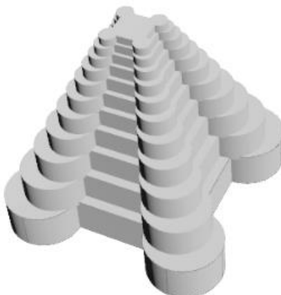
7-rasm. L-tizimlar algoritmidan foydalanib ishlab chiqilgan 3D fraktal bino modeli
