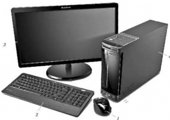
2.5-rasm. Shaxsiy kompyuter (1 – sichqoncha; 2 – klaviatura; 3 – monitor; 4 – tizim bloki).
