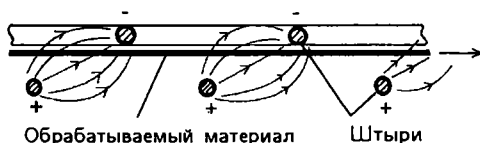
Рис. 3.1.6. ВЧ-нагреватель на связанных ЗС типа «встречные штыри» (стрелкой показано направление перемещения материала)
