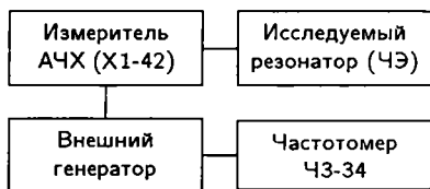
Рис. 4.2.21. Структурная схема измерения резонансной частоты с помощью внешней частотной метки
