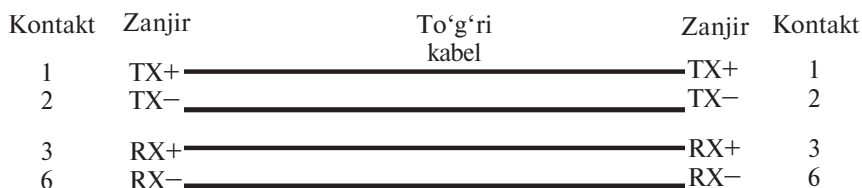
6.9-rasm. 10 BASE-T segmenti toʻgʻri va chorraha kabel simlarining ulanishi.
