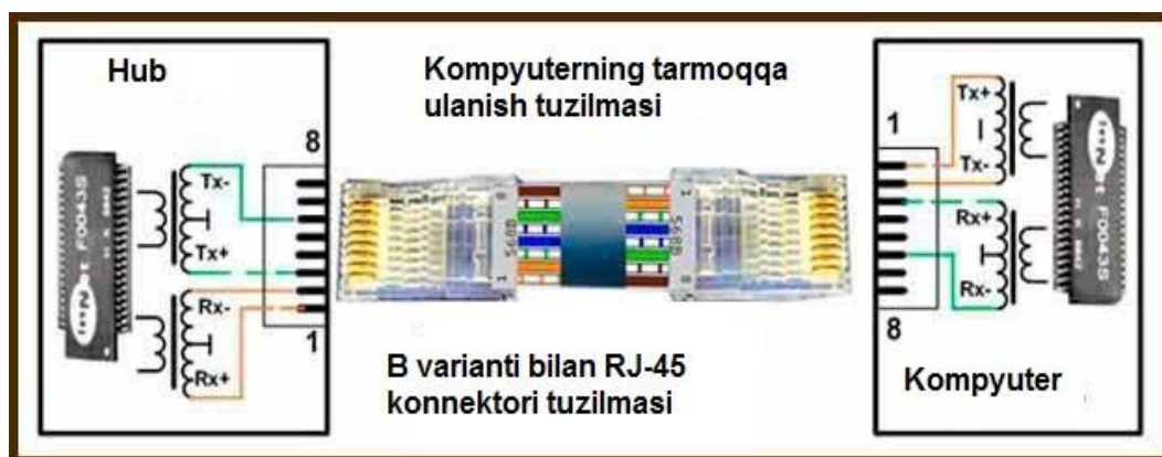
3.6-rasm. Kompyuterning tarmoqqa ulanish tuzilmasi
