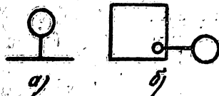
1-расм. Асбобнинг шартли тасвирини уланиш жойини кўрсатмасдан (а) ва кўрсатиб (б) қуриш усули
