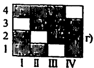
4.1-расм. 3/1 саржа асосида икки юзли қўшимча тандалди тўқимани тахтлаш дастури
