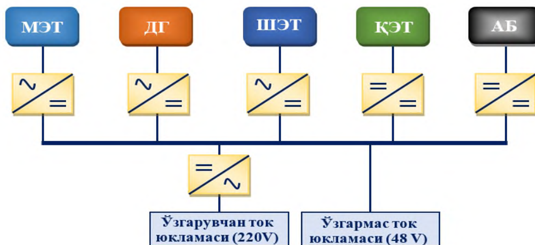
1.8- расм. Телекоммуникация тизимлари энергия таъминотининг ўзгармас ток схемаси
