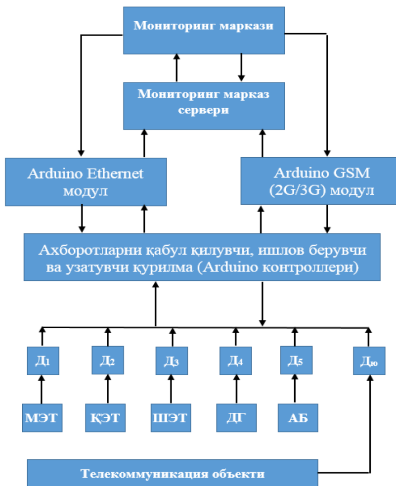
4.8-расм. Бошқарув жараёнини масофали мониторинг қилиш тизимининг тузилиш схемаси
