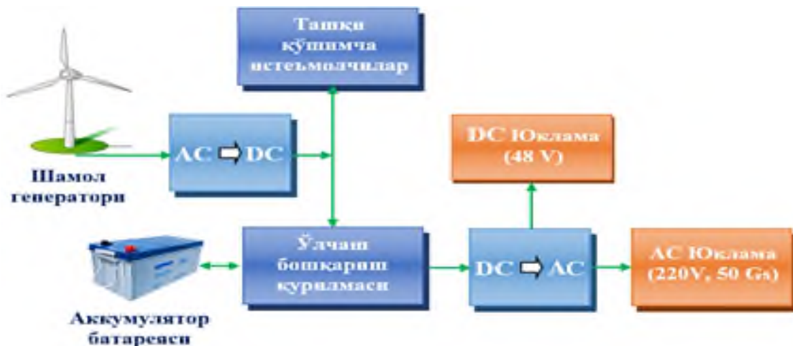
1.5-расм. Шамол энергия таъминоти манбаининг тузилиш схемаси
