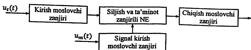
10.1-chizma. Modulyator funksional sxemasi
