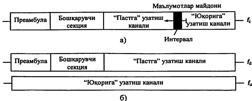
5.10-расм. Каналларни вақтли (а) ва частотавий (б) дублекслашми тизимлар учун IEEE 802.16a стандартидаги кадрлартузилмаси
