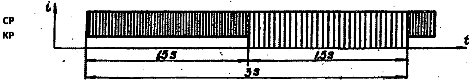
3.18-rasm. Qisqa davr (KP) - OH ko‘rinishidagi tok impulslari seriyasining DH ko‘rinishli tok impulslari seriyasi bilan almashinishi
