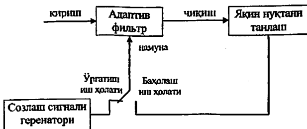
9.6-расм. Алоқа канали частоталар характеристикасини адаптив фильтр ёрдамида тўғрилаш.
