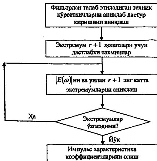
6.8-расм. Оптимал методнинг соддалаштирилган функционал схемаси.
