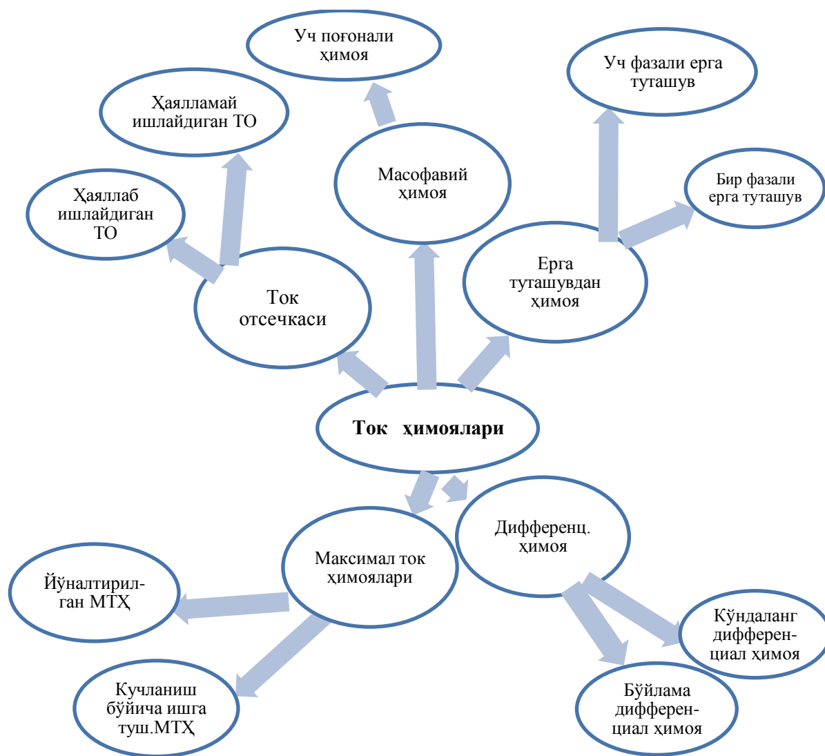
2-расм.Ток химояларига турдош химоялар кластер схемасида.
