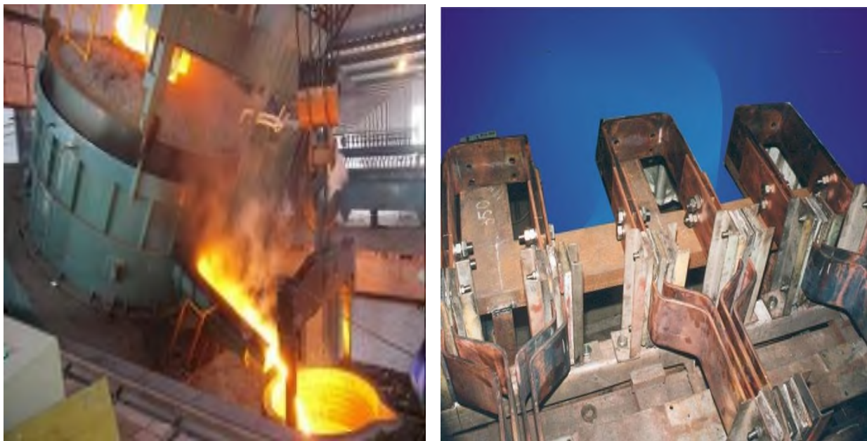
11.2-расм. Эриган металл ашёсини қолипларга қуйиш жараёни (а) ва “қисқа тармоқ” шиналарини уланишларини кўриниши (б)
