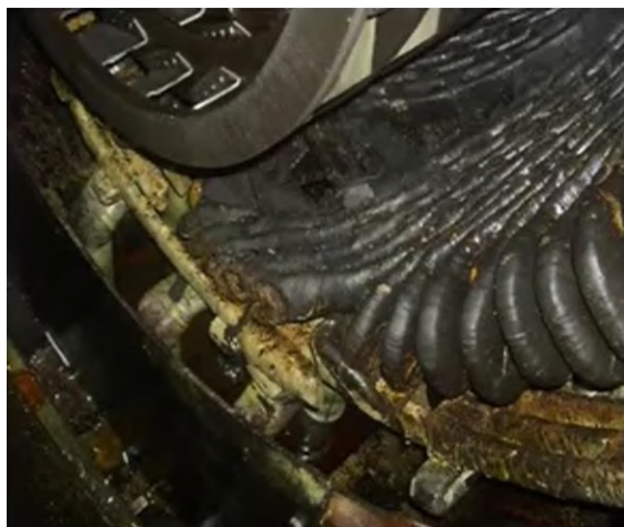
7.2-расм. Синхрон генераторлардаги қисқа туташувлар оқибатидаги шикастланишлар кўринишлари.
