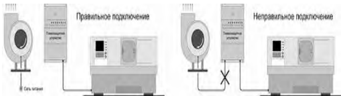
14.21-расм.Халақитлардан ҳимоялаш қурилмасини монтаж қилиш
