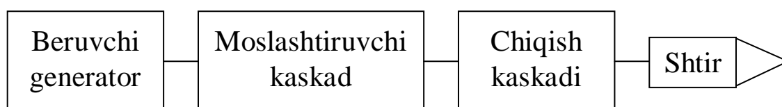
4.16 - rasm. F7244 stimullashtiruvchi generatorning osonlashtirilgan sxemasi
