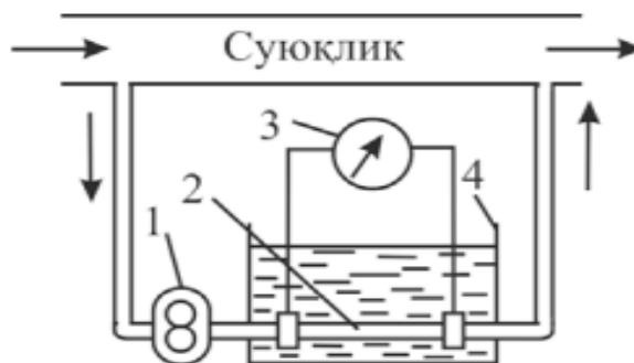
55 – rasm. Avtomatik kapilyar viskozimetrning sxemasi.
