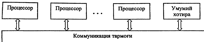
9.1-расм. Кўп процессорли (умумий хотирали) ҳисоблаш системасининг структураси
