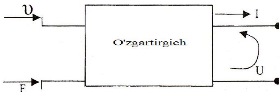
4.1- rasm. Elektromexanik o'zgartirgichning umumiy sxemasi
