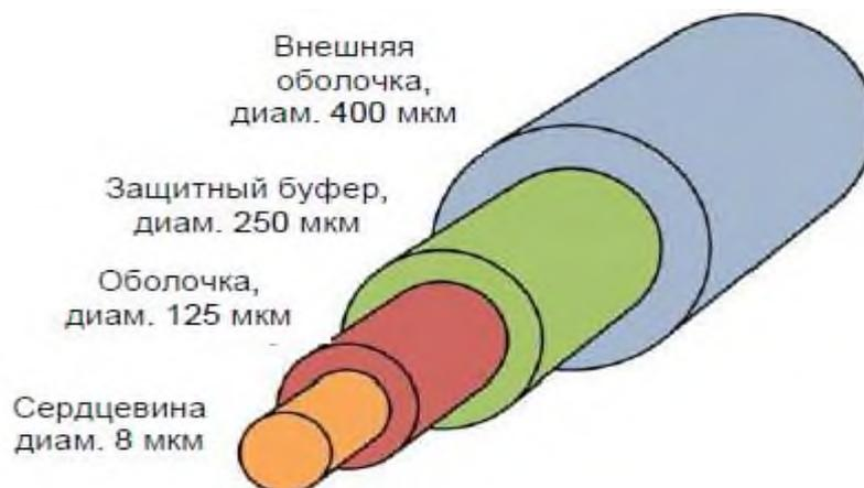
2.32- расм. Бир модали оптик толанинг конструкцияси
