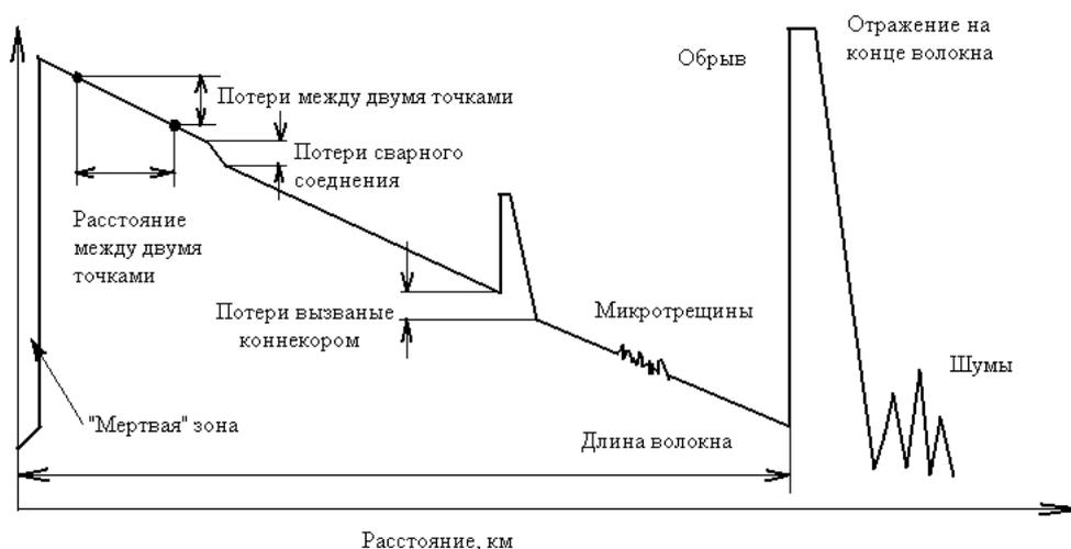
Рис 5.3. ТОАЛ нинг типик рефлектограммаси
