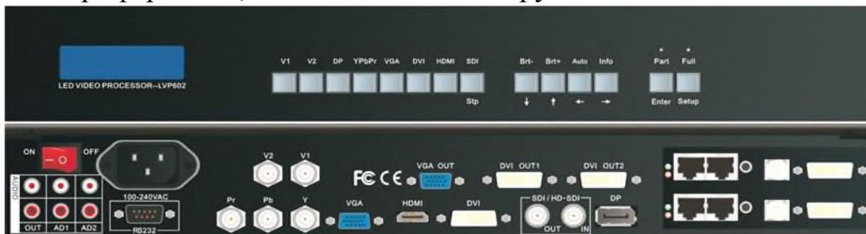
Рис.6.25. Лицевая и задняя панель LED видео процессора
