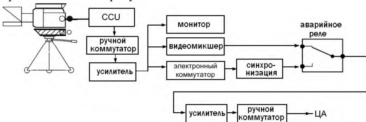
Рис.11.2. Обобщенная схема прохождения сигнала в аппаратных АСБ
