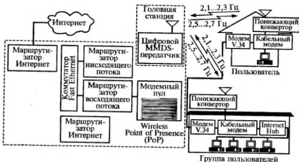
Рис. 14.6. MMDS-система с доступ в Интернет по эфиру.
