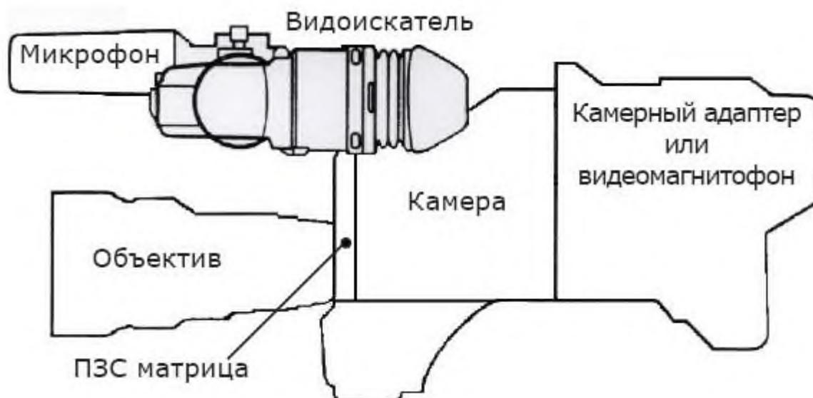
Рис.11.9. Схематичный вид видеокамеры.
