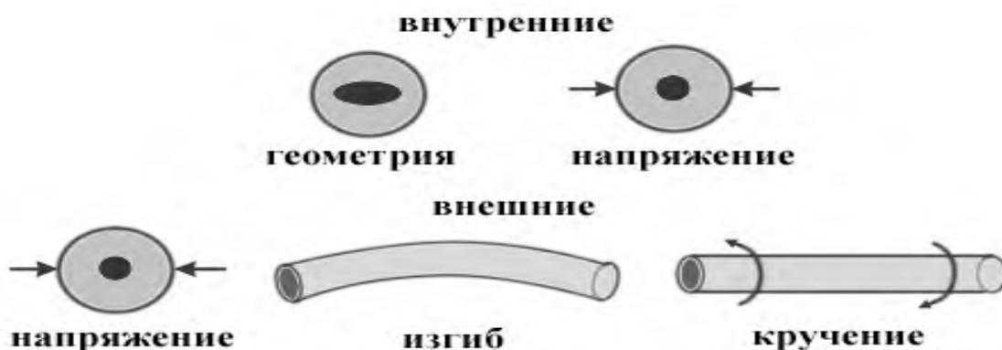
2.21-расм. Оптик толада кутбланган мода дисперсияси(а) ва уларнинг пайдо бўлишига сабаблар(б)
