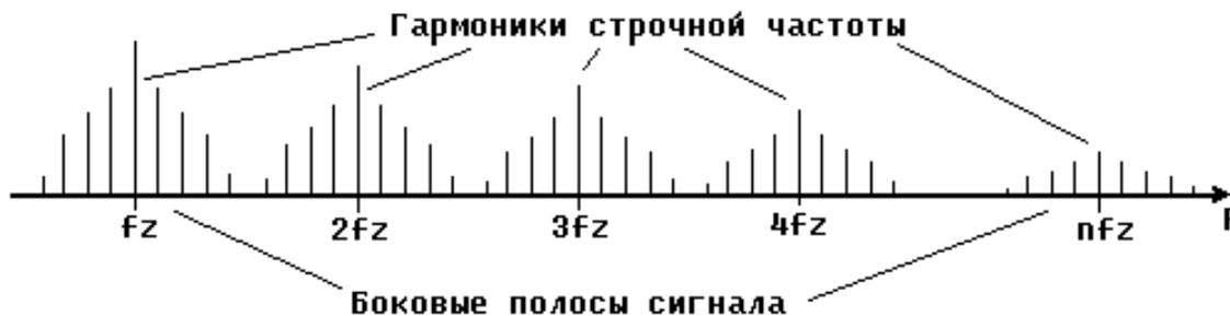
Рис.4.5. Примерный вид спектра ТВ сигнала
