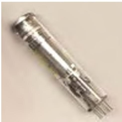
Рис.5.15. Внешний вид трубки типа ПИРОВИДИКОН ЛИ492
