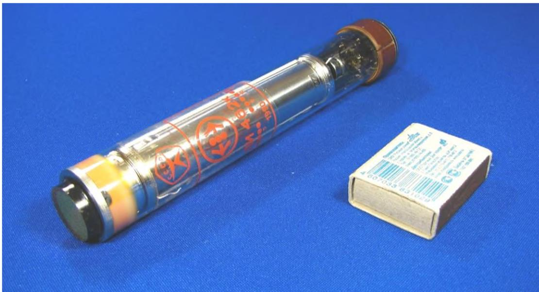
Рис.5.10. Внешний вид трубки типа плюмбикон ЛИ-457, ЛИ-458
