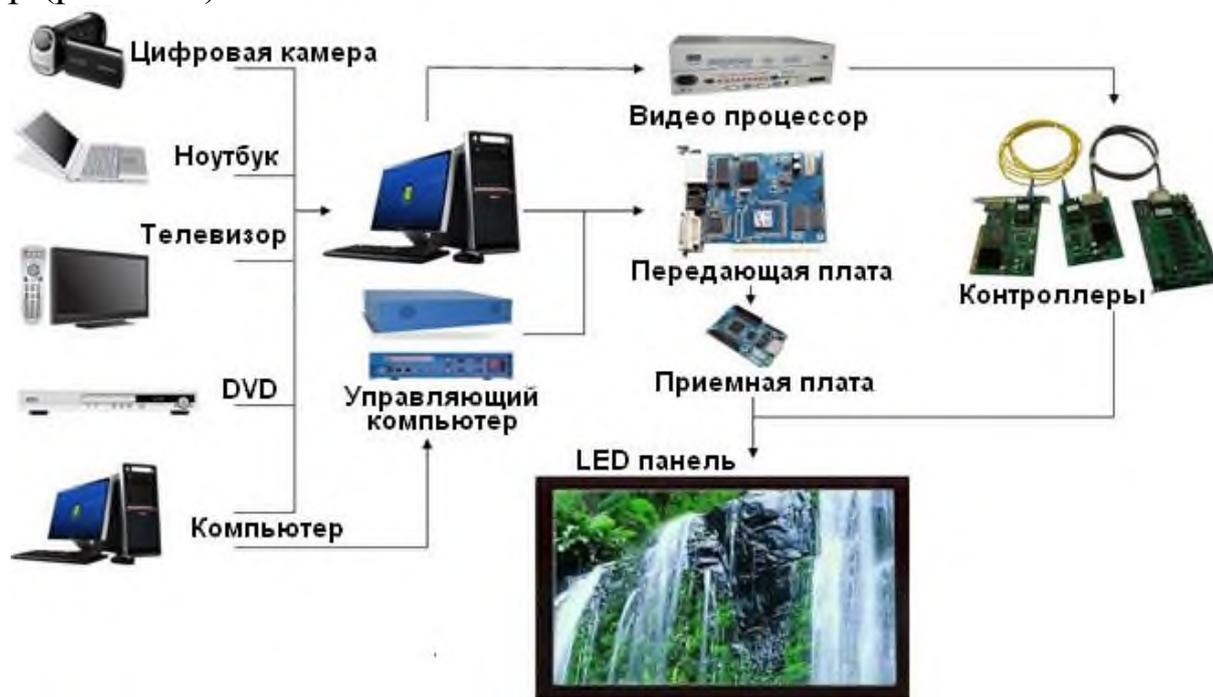
Рис.6.24. Система управления экраном
