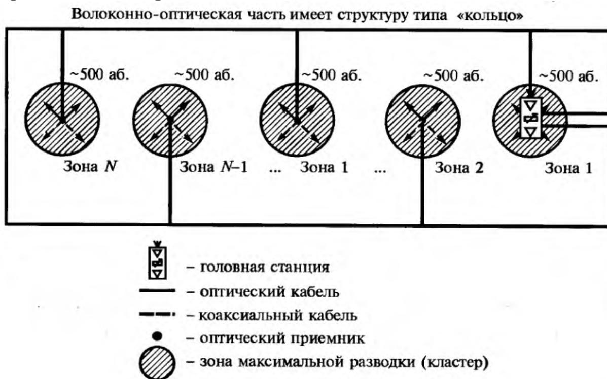
Рис 14.4. Общая структура гибридной СКТ.
