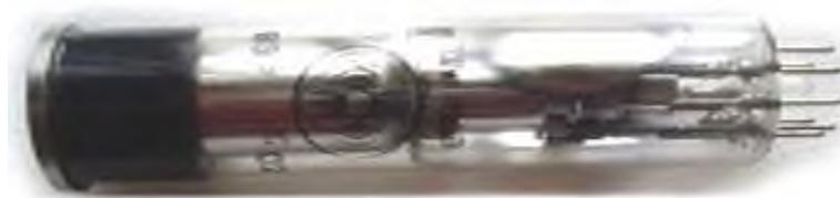
Рис.5.12 Внешний вид трубки типа Кремникон
