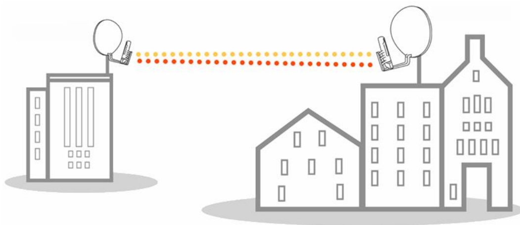
2.6- расм. «Нуқта-нуқта» режимдаги Wi-MAX тармоғи
