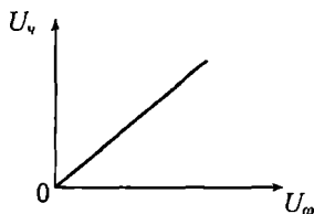
7.11-расм. Синхрон детектор детекторлаш характеристикаси.
