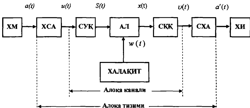
1.1-расм. Алоқа тизимининг структуравий схемаси.
