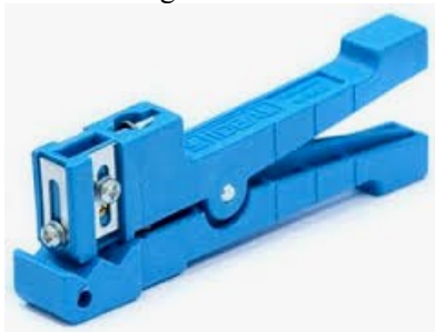
17.16-rasm. Stripper modul kesish asbobi. Optik tolalarni qo'llanuvchi optik kabel muftalarining splays
