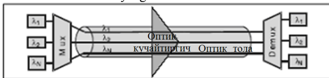
13.3-rasm. WDM tizimlarida optik kuchaytirgich toladan uzatiladigan turli to'liqin uzunlikli signallarni bir vaqtda kuchaytiradi.
