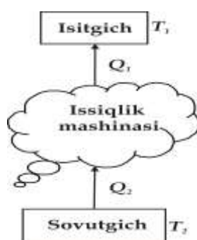
5-rasm. Sovutgich mashinasining tuzilishi
