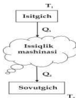
4-rasm. Issiqlik mashinasining tuzilishi.
