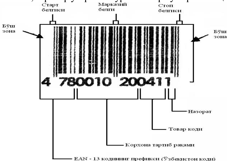
2.2-расм. EAN-13 кодининг структураси.
