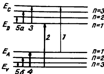
3.7- расм. Яримўтказгичда киришма марказларида ютилиш билан боғлиқ бўлган оптик ўтишлар схемаси;
