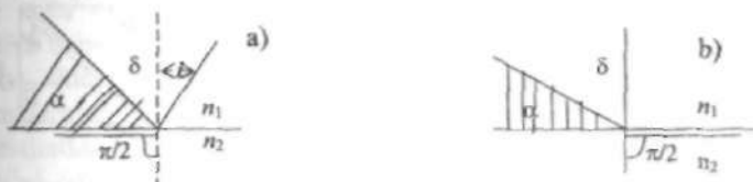
7.1-shakl. Chegaraviy holatda nurning sinishi. a – to'la qaytish holi, b – yarim soya holi bo'ladi.
