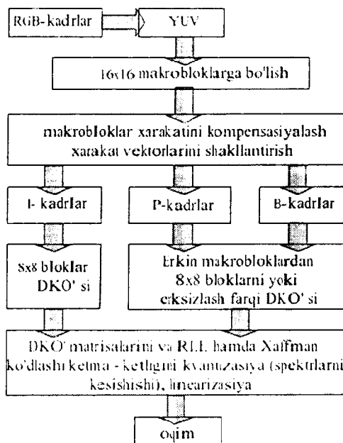
4.12-rasm. MPEG-1 standartida videoni siqish algoritmi.
