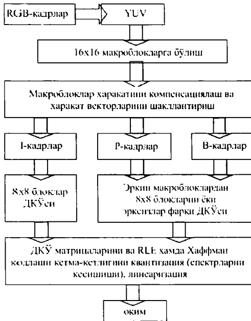
4.12-расм. MPEG-1 стандартида видеони сиқиш алгоритми.
