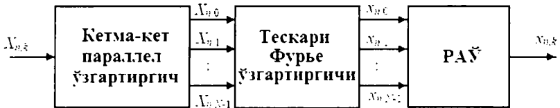
5.9-расм. OFDM сигналини ҳосил қилиш принципи.
