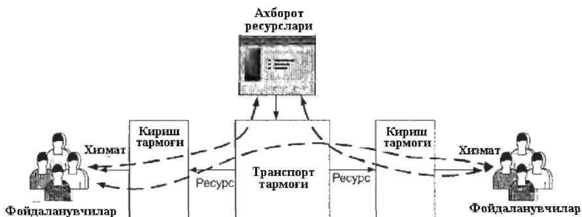
6.77-расм. NGN алоқа тармоғининг тузилиш принциплари.
