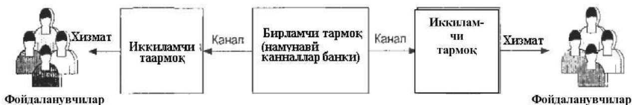
6.73-расм. Анъанавий алоқа тармоғининг ишлаш механизми.
