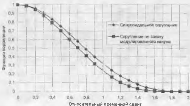
Рис. 2. Функции корреляции сглаженных цифровых сигналов
