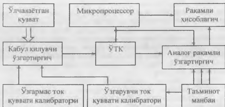
1- Расм. Рақамли ваттметрнинг соддалаштирилган тузилиш схемаси.
