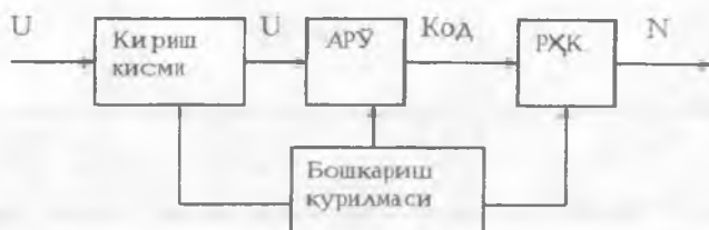
Расм. Рақамли вольтметрнинг тузилиш схемаси
