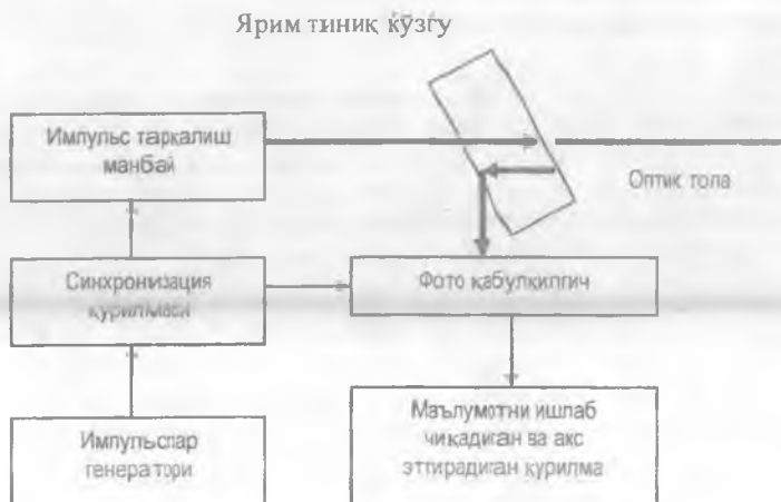
1 расм. Оптиќ рефлектометрнинг соддалаштирилган тузилиш схемаси
