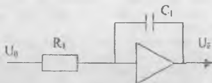
4-расм. Линеаризацияни таъминлаш учун қўлланиладиган интегралловчи бўғин чизмаси.
