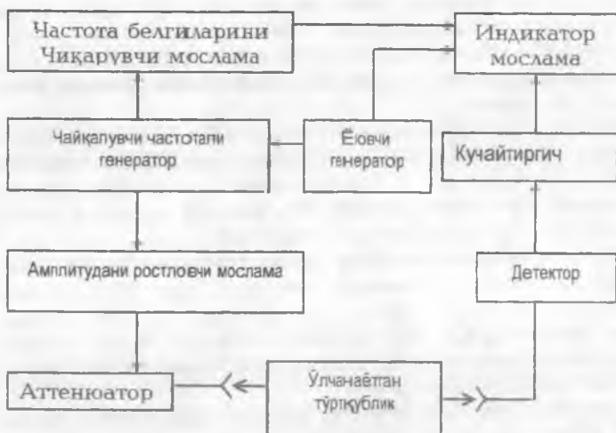
2. расм. АЧХни ўлчовчи асбобнинг тўлиқ схемаси.
